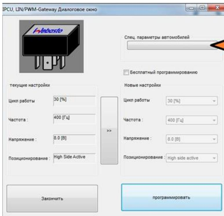
Для программирования IPCU-модуля или GGW-модуля в режим ШИМ-модуляции необходимо выбрать автомобиль в меню «Спец. параметры автомобилей» или ввести параметры вручную, воспользовавшись опцией «Бесплатный программирование» («Free programming» - свободное программирование).
