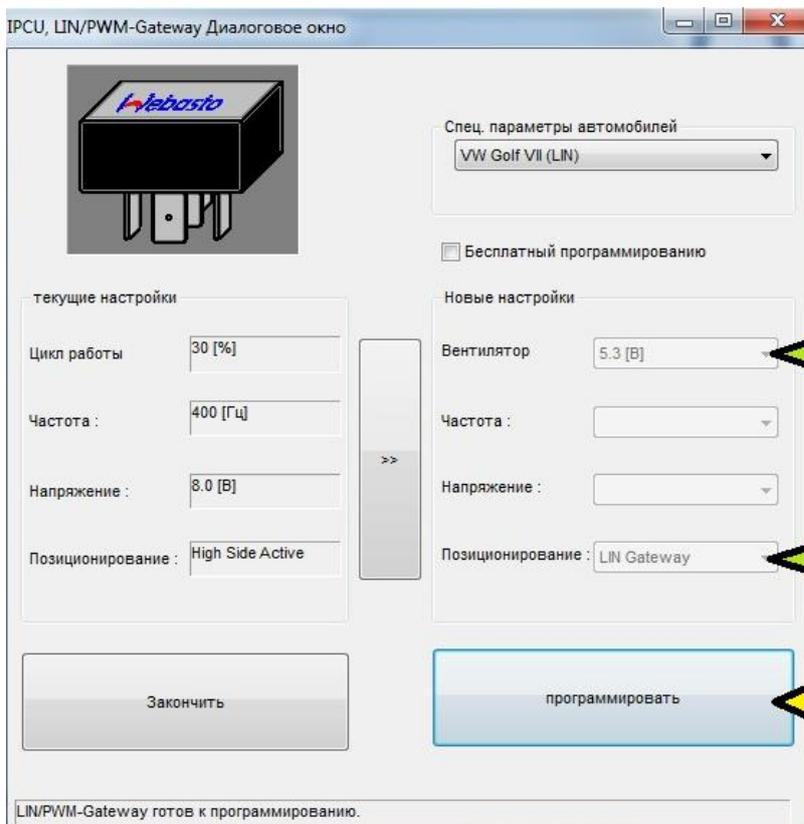
Параметр «Позиционирование» примет значение «LIN Gateway»
